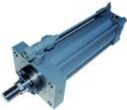
Bild 1: Verriegelungszyylinder in Zugstangenbauweise für einen maximalen Betriebsdruck von 160 bar. Er wird unter anderem in Montageanlagen, in Hochdruck-Umformmaschinen und bei Absperrarmaturen verwendet.
