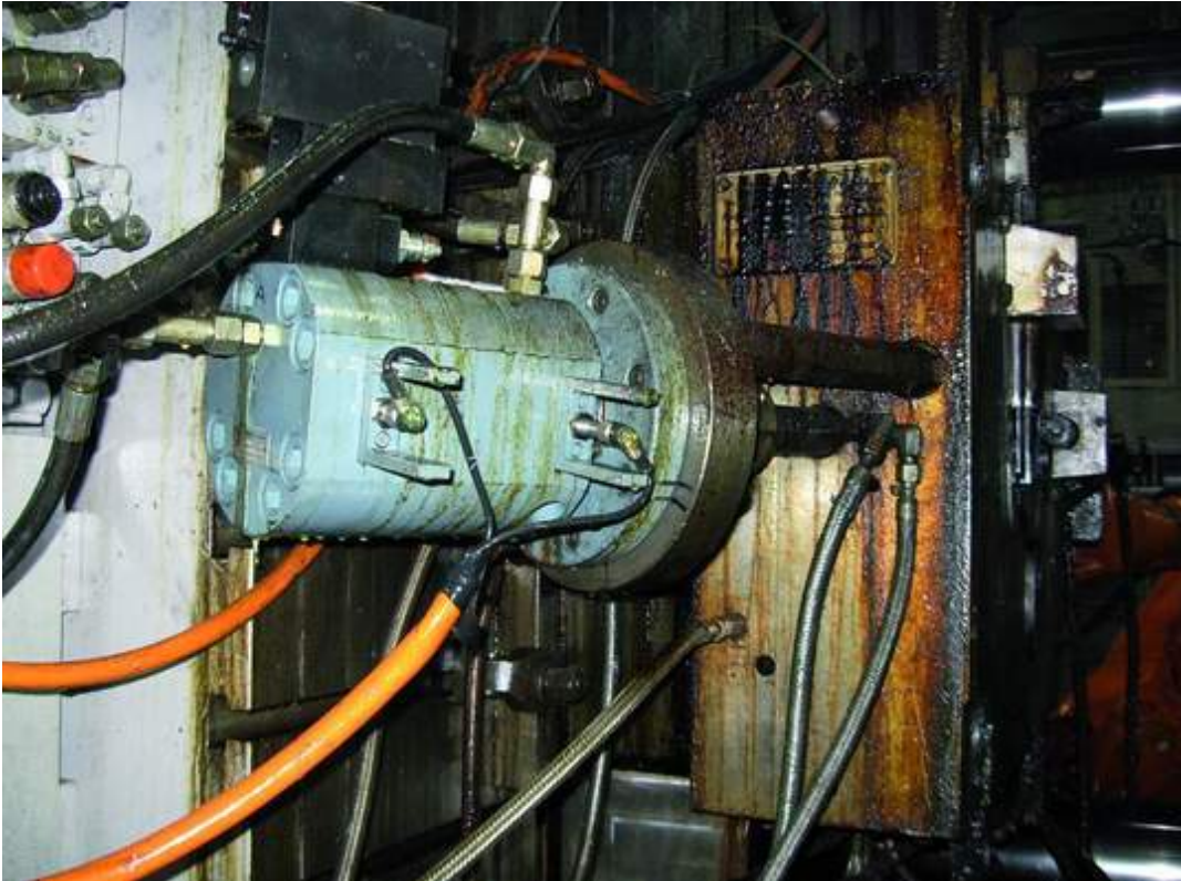
Bild 4: Zylinder mit kraftverstärkter hydraulischer Verriegelung in einer Druckgießmaschine für Aluminium- und Magnesiumteile. Die Belastung der Zylinder durch thermische und mechanische Einflüsse ist sehr hoch. Bilder: Hydropneu
