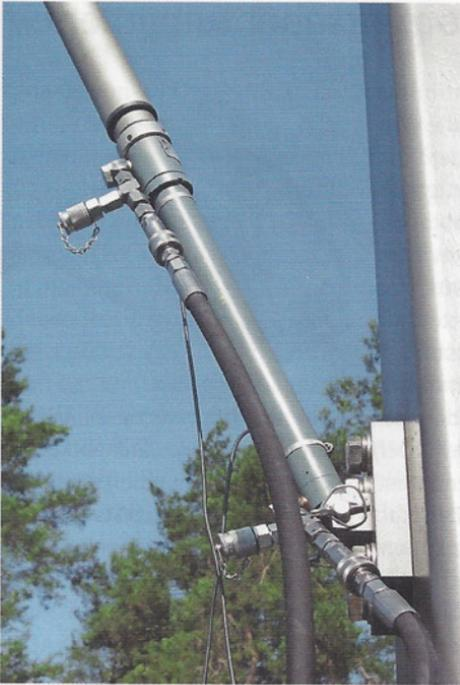
Dieser Hydraulikzylinder mit einfach verstellbarem Näherungsschalter betätigt die Stromzuführung zur Oberleitung einer Straßenbahn
